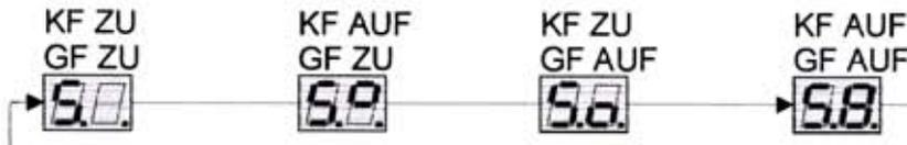
Funktionskennziffer 6 = Ventilrichtung
